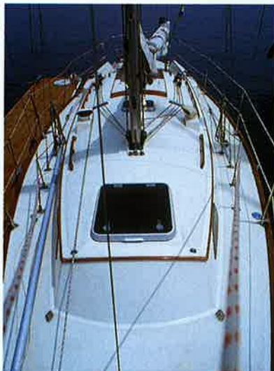
全長4mという箱型のキャビンハウスが、ほとんど同じ高さでパウデッキまで続いている。テンドー用のゴムボートは、ハウスの前端とインナーフォアステイとの間のすきまに収納していたそう
