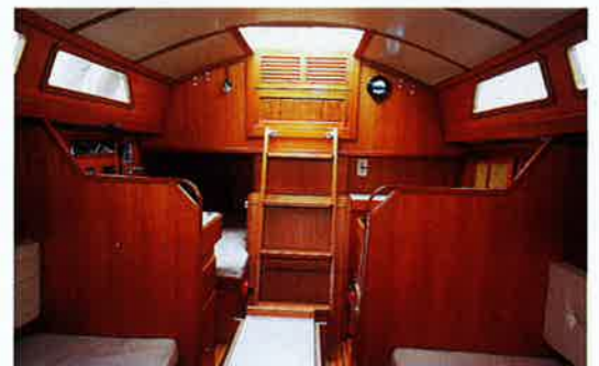
船内のインテリアはすべてチーク製。ヘッドクリアランスは1770mm。これがずっとフォクスルバースまで続く。トイレはメインバルクヘッドの前方にあるので、入り口付近は視界を遮るものがなく広々としている
