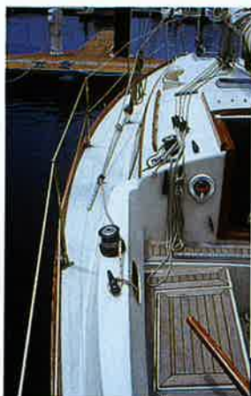
2階建てのcockpitロッカーの「地階」から出てきたチェーンは、専用の200mmクリートを経て、トランサムの方口ローラーにリードされる。このローラーはチーク製の厚板のオーバーハングの上に載っているため、ロープやチェーンがハルを傷める心配は少ない
