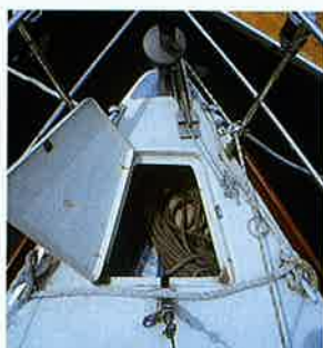
パウのアンカーbinは、入り口は300×300mmと小さいが、中は600×700mmとかなり広い。深さも300mmあるので、容量は大きい。ステムヘッドのアンカーは7.5kgのブルース
