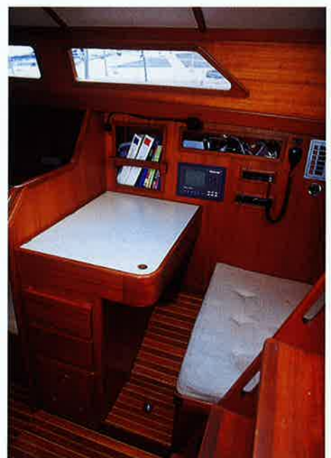
チャートテーブル下のチャート入れは深さが100mmなので、ボリュームは十分だ。座席はクォーターバースを兼用している。このバースは幅は780mmもあるのだが、長さのほうは1840mmとちょっと物足りない。天井高は700mm。バースの下には小型のバッテリーが2本入っている
