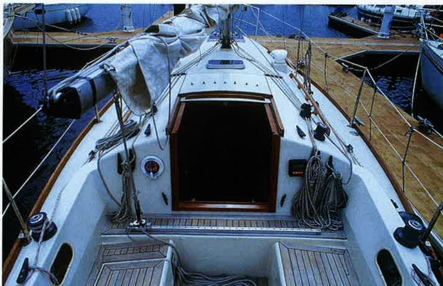
木枠のついたスライドハッチに、チークのcockpitやハンドレールがよくマッチしている。ウインチはハウスの上がハーケン8番、cockpitがバルパロッサの16番だが、ジェノアが大きいので、特にシートウインチのほうはもうひとまわり大きくてもよかったかもしれない
